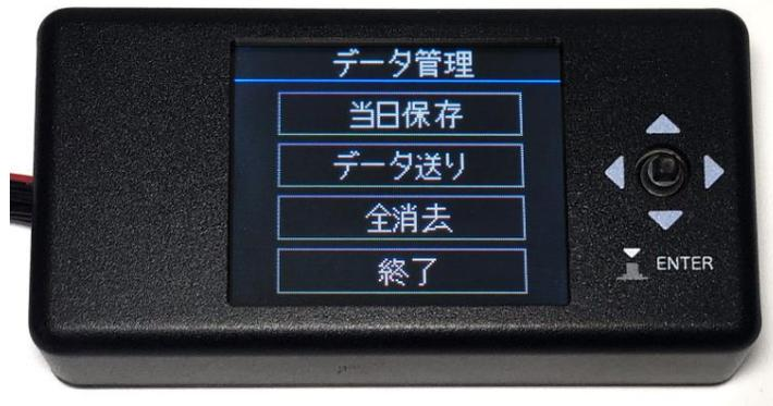
この画面で十字キーを押下すると選択カーソルが点滅し始めますので、十字キーの上下方向で当日データをセーブ、データ送り、全データ消去の3項目のいずれかを選択します。メイン画面に戻るには「終了」を選択し、カーソルの点滅を消してから十字キーを上方向に押下します。
