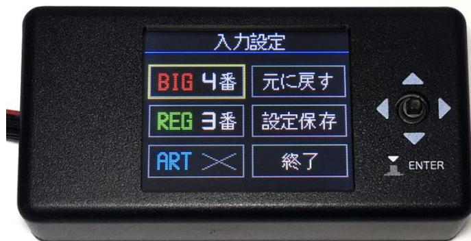
この画面で十字キーを押下すると選択カーソルが点滅し始めますので、BIG、REG、ARTのいずれかにカーソルを合わせてから十字キーを押下するとピン番号が変わります。該当するボーナスが無い場合は「X」を選択して下さい。設定が終わりましたら設定保存を選択します。移動は上下左右方向に対応します。メイン画面に戻るには「終了」を選択し、カーソルの点滅を消してから十字キーを下方向に押下します。
