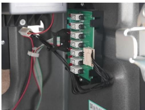
スロット台背面の穴から「スロット⇔本体接続ケーブル」のベージュ色のコネクタを通し、リール横にある集中端子盤に挿し込んで下さい。
